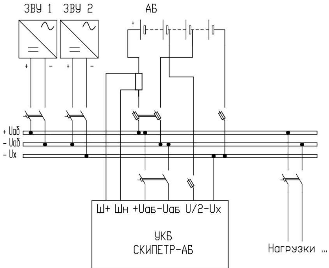
Рис.2. Типовая схема подключения УКБ в СОПТ.
